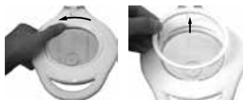
Fig. 39: Sostituzione della luce della lente
