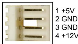
Für X5V oder X12V Einstellung (JP2) muss J2 mit dem PC Netzteil verbunden werden! Sonst wird die Karte nicht mit Strom versorgt.
