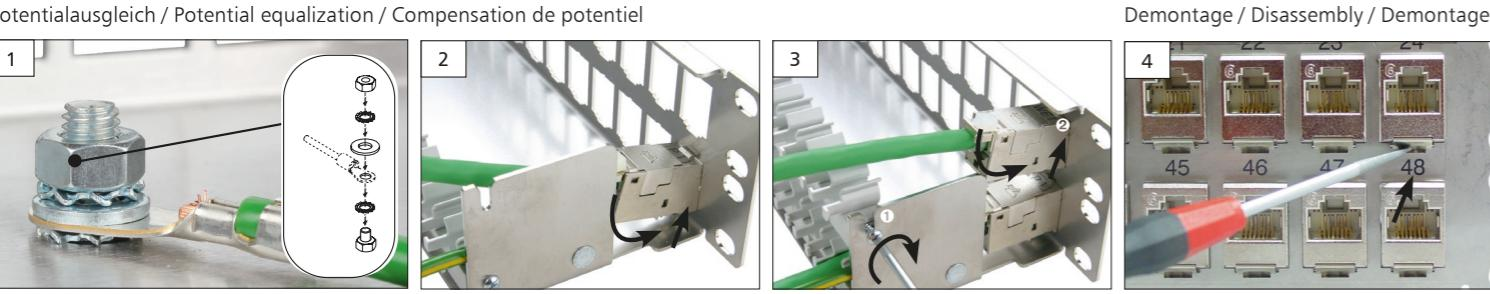
**D** Modulmontage im 19" Modulträger 1HE 6 Port / Module assembly in 19" module frame 1RU 6 port/
