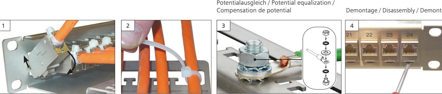
**C** Modulmontage im 19" Modulträger 1,5HE 48 Port Edelstahl / Module assembly in 19" module frame 1.5RU 48 port stainless steel/
