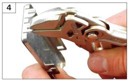
Bervor der Gehäusedeckel aufgerastet wird, jeweils an den entsprechenden Seiten mit einer Zange die Halterung-/en abtrennen. Remove the brackets on the respective sides with pliers before the housing cover is snapped on.
