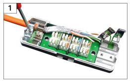
Zugentlastung und Schirmanschluss anbringen. Hinweis: Für eine optimale übertragungstechnische Performance muß der Paarschirm direkt bis zum LSA-Klemmkontakt geführt werden.
